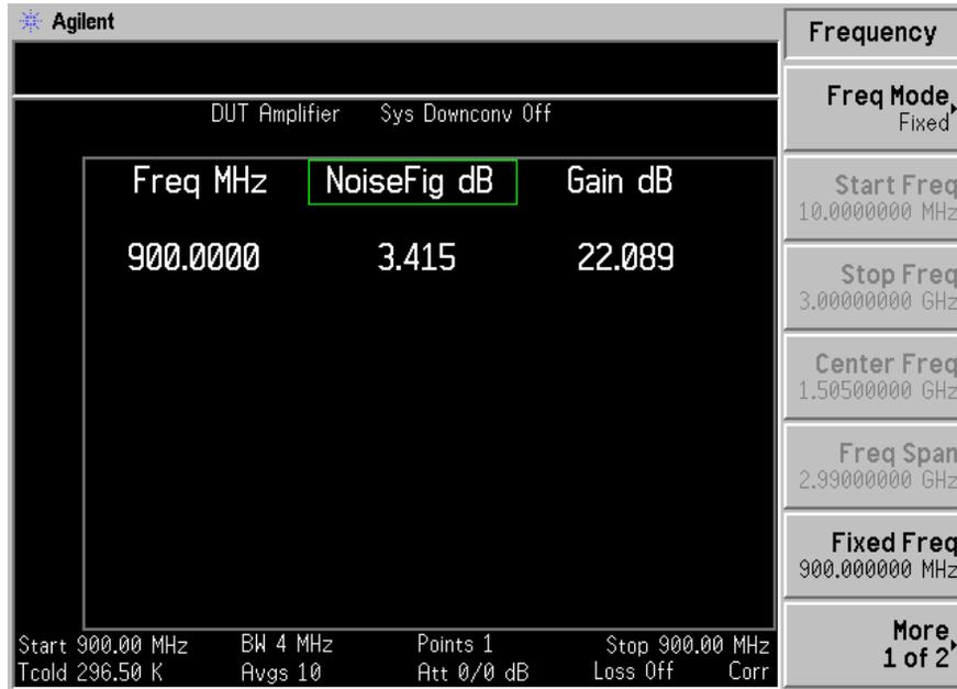
圖 1-7 顯示的結果是 DUT（接受測試的裝置）在 900 MHz 的雜訊指數和增益。
