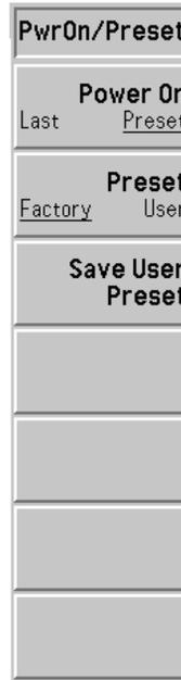
**Power On** 「開機」鍵決定 NFA 開機時所處的狀態。如果該功能設定為 **Power On(Pres)** (開機 (預設))，NFA 開機時所處的狀態和按下 **Pres** 後所處的狀態相同。如果該功能設定為 **Power On(Last)** (開機 (最後))，NFA 開機時調用其最後一次關機時所處的狀態。
