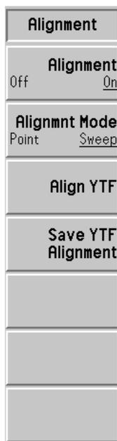
**Alignment** 選擇 **Alignment(On)** (調準 (開啓))，啓用 NFA 的自動調準功能，這是預設值。選擇 **Alignment(Off)** (調準 (關閉))，則禁用自動調準功能。
