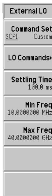
**Command Set** 「指令集」鍵用於設定外接 LO 指令語言。設定 **Command Set(SCPI)** (指令集 (SCPI))，可使用內置指令驅動符合 SCPI 規格的 LO。如果外接 LO 不具備 SCPI 相容功能，可設定 **Command Set(Custom)** (指令集 (自訂))，輸入自訂指令串。
